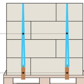
02 Vertikale Palettensicherung in Verbindung mit sanstrap® Dehnbändern
