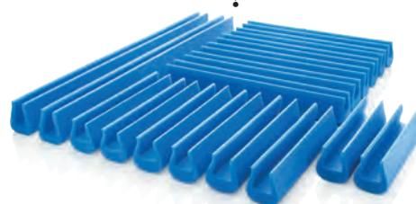
09 **Zuschnittsatz** bestehend aus: 6 Teile **NOMAPACK® Schaumprofil U-Tulpe 30-45/55** à ca. 330 mm Länge, 6 Teile **NOMAPACK® Schaumprofil U-Tulpe 30-40/70** à ca. 890 mm Länge, 6 Teile **NOMAPACK® Schaumprofil U-Tulpe 30-45/55** à ca. 500 mm Länge und 2 Teile **NOMAPACK® Schaumprofil U-Tulpe 30-45/55** à ca. 280 mm Länge.
