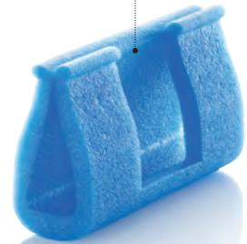
06 Zuschnitt aus NOMAPACK® Schaumprofil U-Tulpe 0-30/70, ca. 160 mm lang, mit einseitigem, mittigen Ausschnitt ca. 63 mm, als besonderer Kantenschutz.
